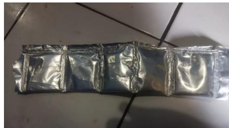
Gambar 11. Hasil pengepresan plastik pada suhu 200°C
