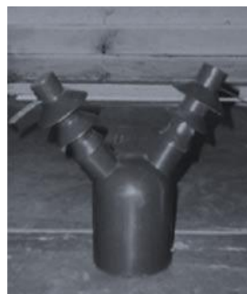
Gambar 3. Material isolasi resin epoksi pada trafo arus distribusi pasangan luar
