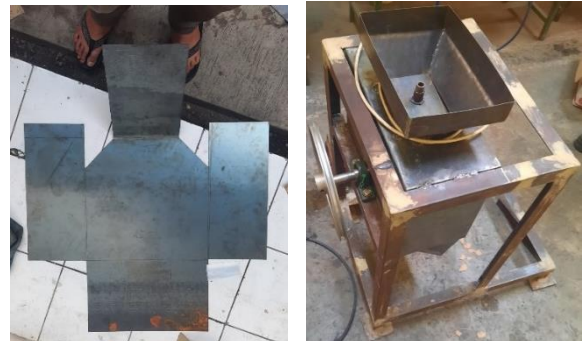
Gambar 6. Proses Pembuatan Hoper Penggiling
