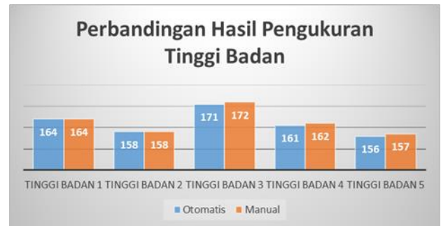
Gambar 15. Grafik Perbandingan Hasil Pengukuran Tinggi Badan Secara Otomatis Dan Manual
