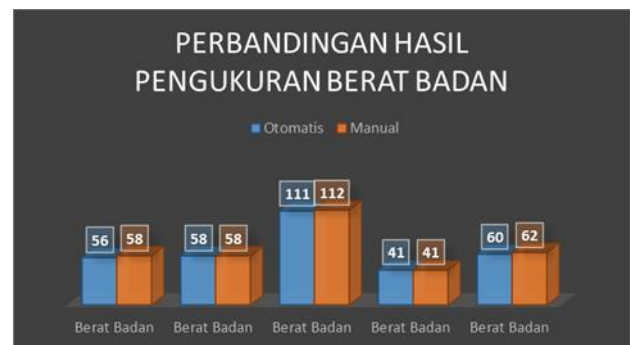
Gambar 16. Grafik Perbandingan Hasil Pengukuran Berat Badan Secara Otomatis Dan Manual
