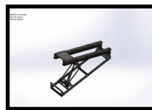
Gambar 11. Model yang sudah di meshing
