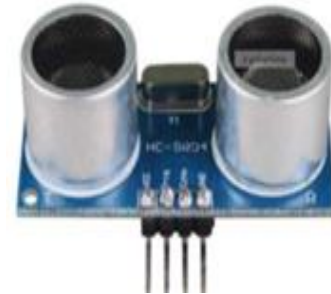
Gambar 11. Bentuk Fisik Sensor Ultrasonik HC-SR04 (Elekfreak, 2000)
