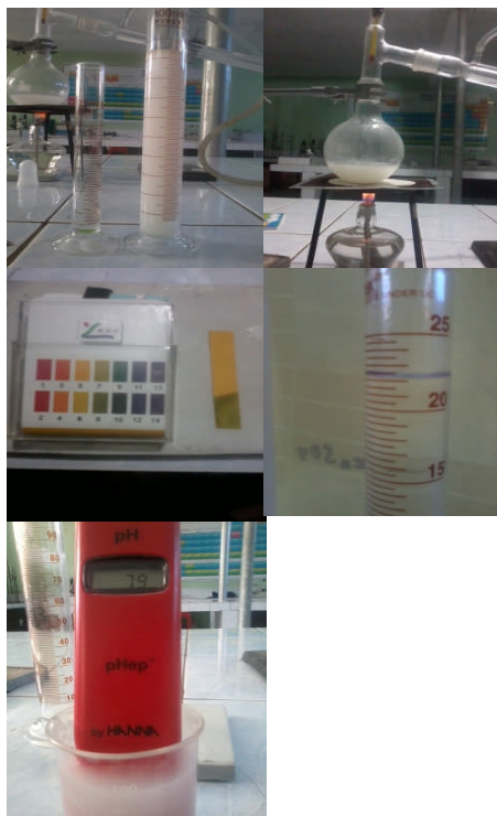
Gambar 4.1 Pengamatan dan analisis pada coolant murni
