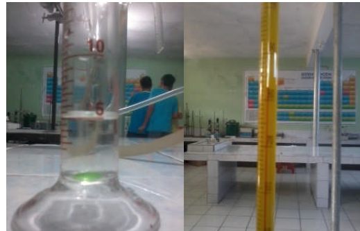
Gambar 4.2. Pengamatan dan analisis pada coolant yang tercampur dengan oli
