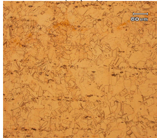
Gambar 15 Struktur awal tembaga tanpa deformasi dianil pada 550°C (sampel 7)
