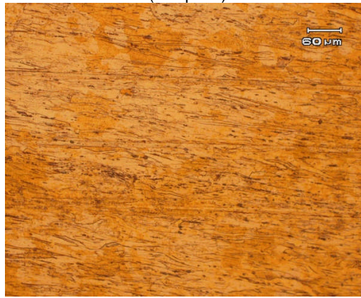
Gambar 14 Roll dingin dengan deformasi 0.69 (sampel 6)
