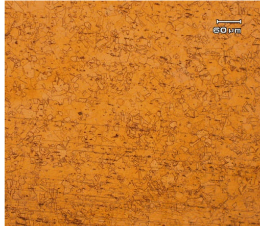
Gambar 19 Roll dingin dengan deformasi 0.54 dianil pada 550°C (sampel 11)
