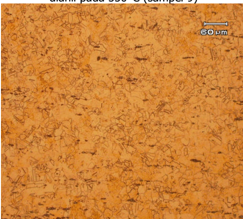
Gambar 18 Roll dingin dengan deformasi 0.42 dianil pada 550°C (sampel 10)
