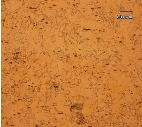
Gambar 16 Roll dingin dengan deformasi 0.11 dianil pada 550°C (sampel 8)
