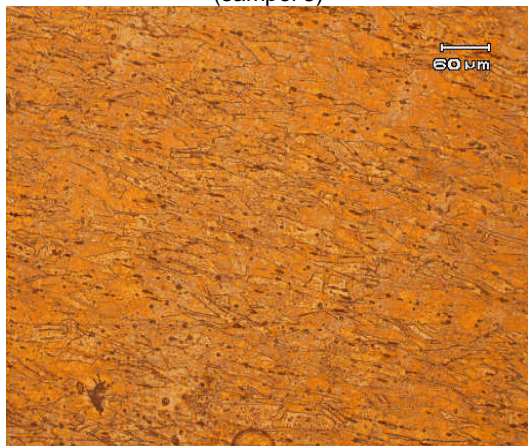
Gambar 12 Roll dingin dengan deformasi 0.42 (sampel 4)
