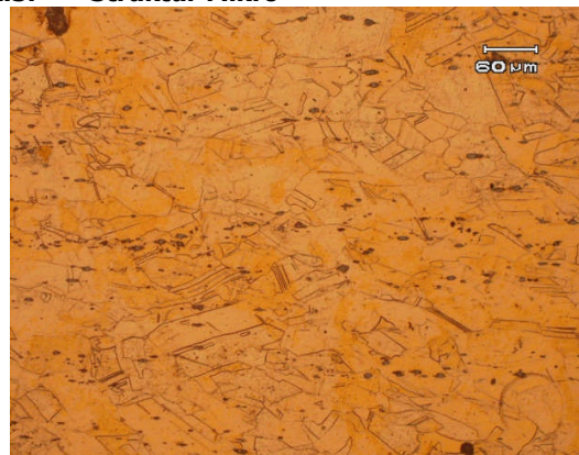
Gambar 9 Struktur awal tembaga tanpa deformasi (sampel 1)
