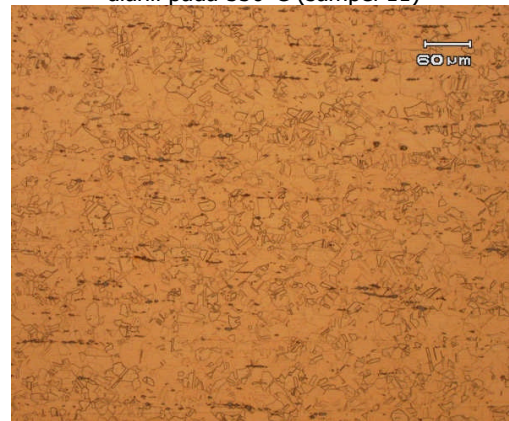
Gambar 20 Roll dingin dengan deformasi 0.69 dianil pada 550°C (sampel 12)
