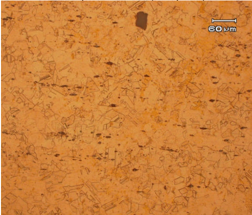
Gambar 17 Roll dingin dengan deformasi 0.30 dianil pada 550°C (sampel 9)
