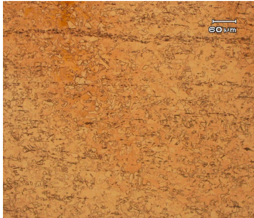
Gambar 22 Roll dingin dengan deformasi 0.69 dianil pada 300°C (sampel 14)
