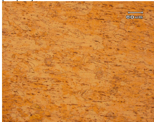
Gambar 11 Roll dingin dengan deformasi 0.30 (sampel 3)
