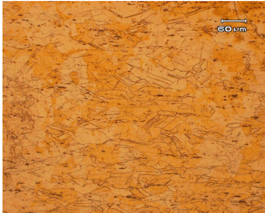
Gambar 10 Roll dingin dengan deformasi 0.11 (sampel 2)
