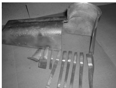
Gambar 8. Pemotongan dan penyiapan spesimen uji
