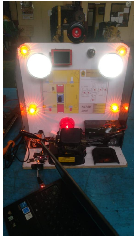
Gambar 4. Implementasi Fisik Sistem Lampu Kendaraan 12V sebagai Validasi Hasil Simulasi
