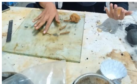
Gambar 5. Uji Plastisitas Tanah
