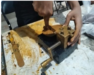
Gambar 4. Uji Batas Cair Tanah
