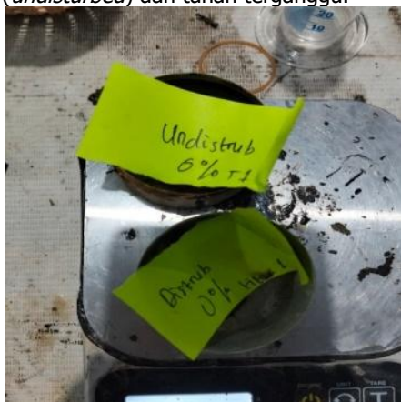
Gambar 1. Uji Kadar Air Tanah
