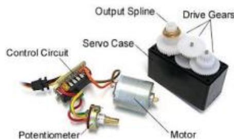
Gambar 1. Komponen bagian dalam motor servo (Achyar, 2013)
