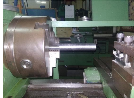
Gambar 0. Proses Pembubutan Poros
