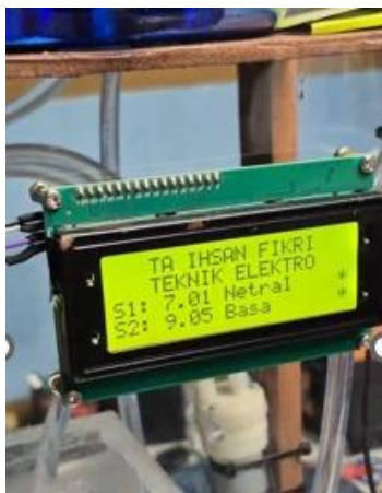
Gambar 4.4 Tampilan LCD percobaan 1 (S1: 7,01 Netral; S2: 9,05 Basa)
