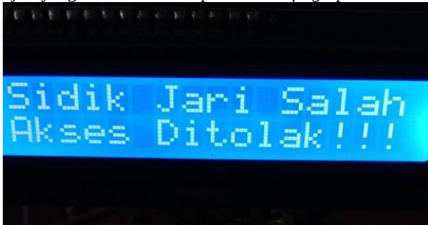
Gbr.9. hasil pengujian sensor fingerprint ketika mendapatkan data yang tidak terdaftar
