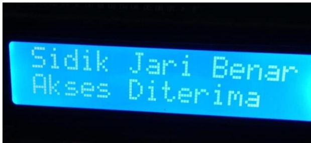
Gbr.8. hasil pengujian sensor fingerprint yang telah terdaftar
