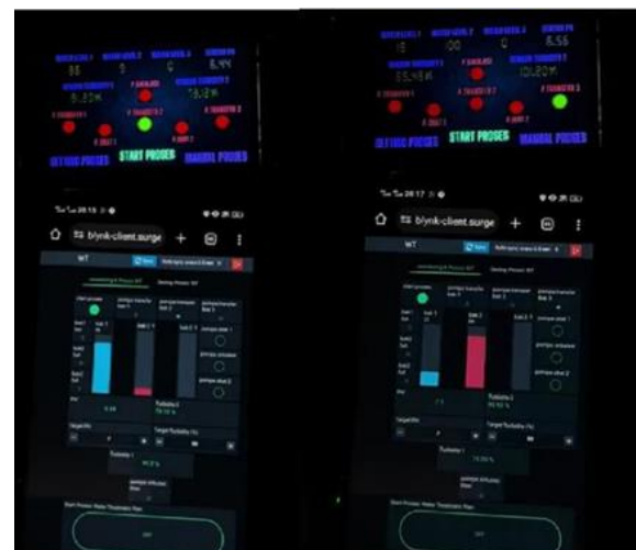
Gbr. 16 Indikator pompa transfer bak 2 dan bak 3 on pada kedua sistem sinkron
