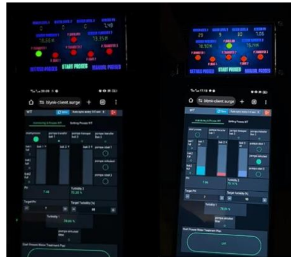
Gbr. 14 Indikator transfer bak 1 dan sirkulasi pada kedua sistem sinkron
