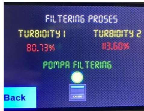
Gbr. 19 Tampilan pada HMI Nextion saat alarm sensor tidak tercapai
