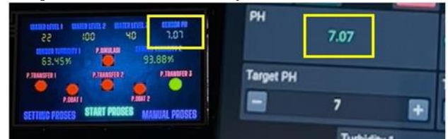
Gbr. 8 Hasil nilai sensor pH pada HMI Nextion dan Blynk
