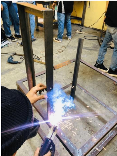
Gambar 8. Proses Pengelasan Mesin Pengaduk Dodol
