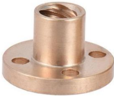
Gambar 4. Mur Ulir Penggerak ( Nut ) Leadscrew Nut Type Trapesium, Lead Pitch (antar gang) 2 mm, jumlah kepala ulir 4, Inner Diameter Ø 8 mm, Structure Trapezoidal (trapesium) dan Material Brass (kuningan)
