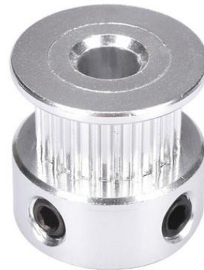
Gambar 7. Puli GT 2 Puli yang digunakan adalah puli GT2 dengan ukuran diameter dalam 6 mm dengan spesifikasi: Material : aluminum alloy Jumlah gigi : 20 Diameter lubang : 5 mm Sabuk : GT2 – 6 mm
