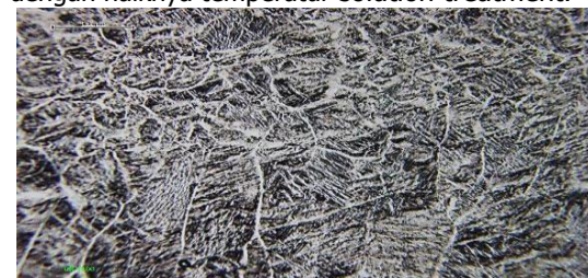
Gambar 17. Penambahan 2% Al Solution treatment 1100°C dan Pembesaran 200x (Sumber: Hasil Penelitian)
