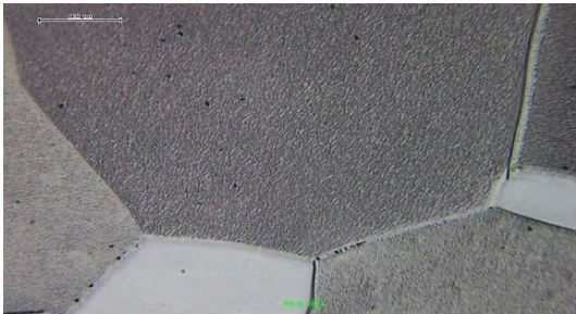
Gambar 20. Penambahan 4% Al Solution Treatment 1000°C dan Pembesaran 200x (Sumber: Hasil Penelitian)
