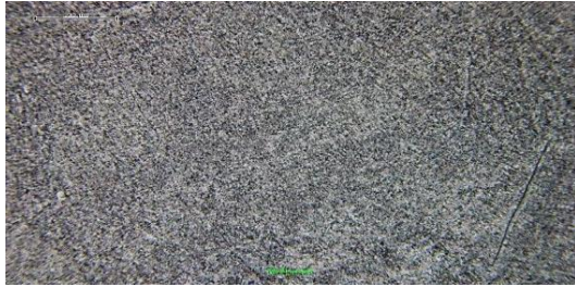
Gambar 18. Penambahan 4% Al as-cast dan Pembesaran 200x (Sumber: Hasil Penelitian)
