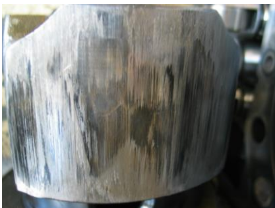
Gambar 7. Perubahan warna dan goresan pada piston skirt
