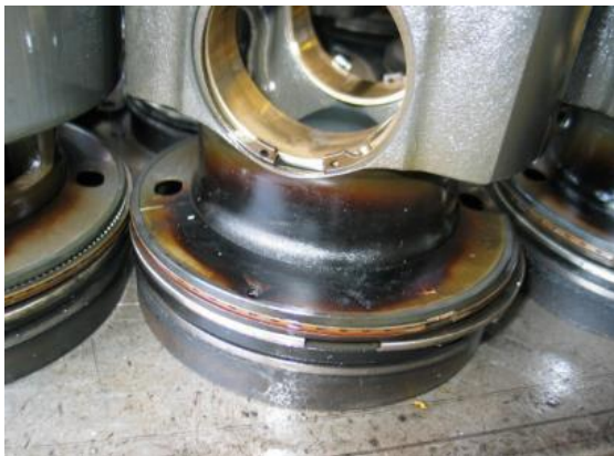
Gambar 6. Perubahan warna karena panas berlebih pada piston monotherm
