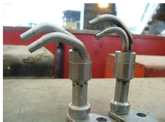
Gambar 10. Piston cooling jet. Kiri, untuk monotherm piston type , dan kanan, untuk two pieces piston type .
