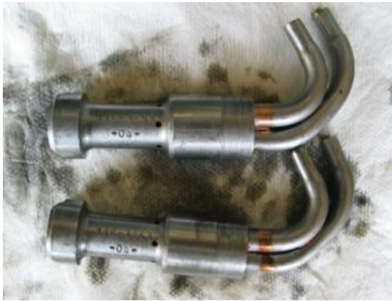
Gambar 5. Piston cooling jet yang dipakai engine
