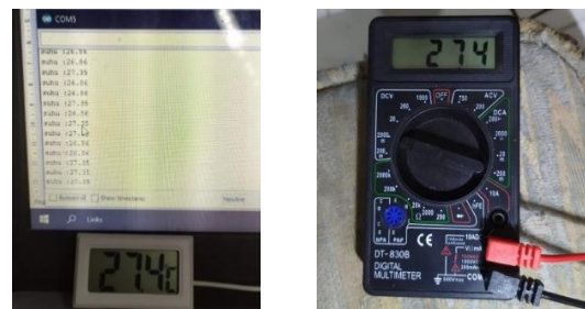
Gambar 19. Pengujian Sensor Pada Suhu 27,4 °C
