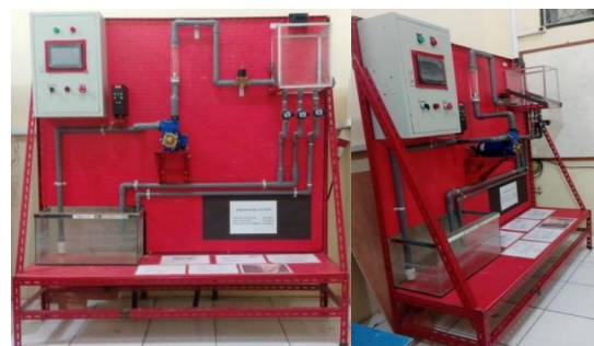
Gambar 24. Sistem pengendalian ketinggian air
