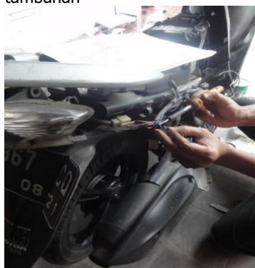
Gambar 4. Pemasangan pada lampu sein dan starter
