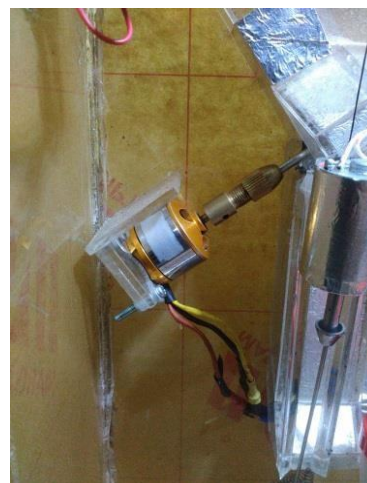
Gambar 5. Motor brushless dan mini rotating saw
