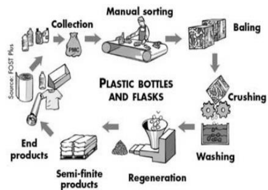
Gambar 4. Skema proses daur ulang plastik
