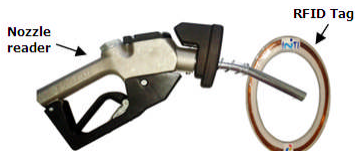
Gambar 12. Posisi Nozzle reader saat membaca data dari RFID tag
