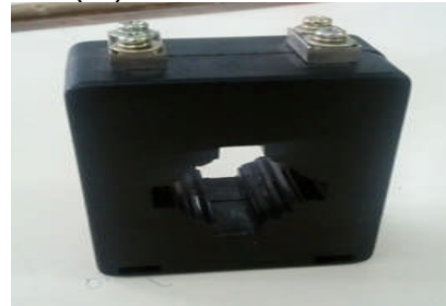
Gambar 3.3 Trafo Arus (CT)
