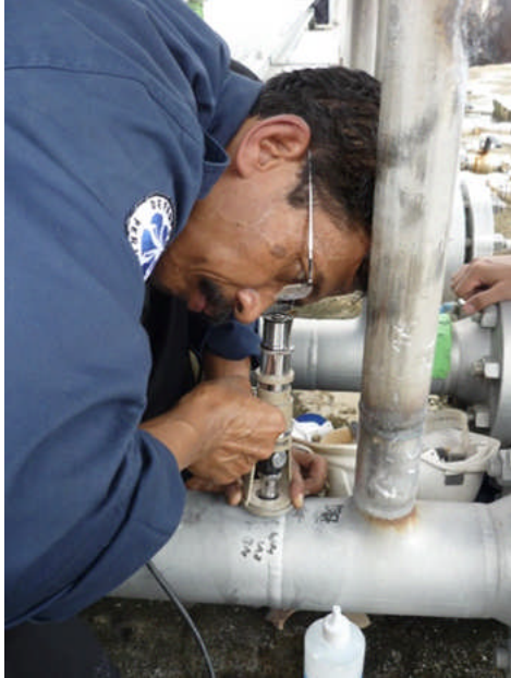
Gambar-5. Observasi Permukaan Hasil Proses Pemolesan pada Pipa
