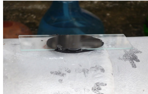
Gambar-7. Replika yang Terpasang pada Spesimen Tertempel pada Preparat
