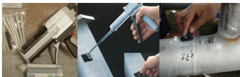
Gambar-6. Microset Surface Replication Kit dan Penempelan Replika pada Material
