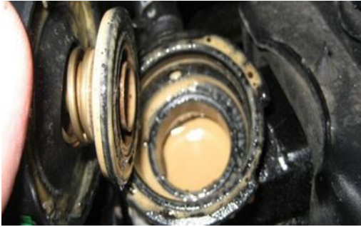
Gambar 4. Air Radiator Yang Kotor
