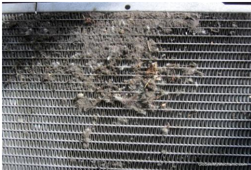
Gambar 11. Sirip Radiator Terdapat Kotoran
