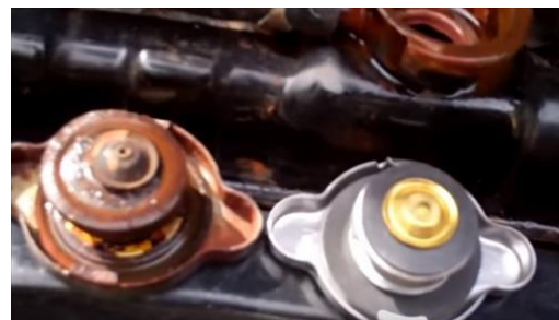
Gambar 9. Tutup Radiator Kondisi Baik dan Buruk
