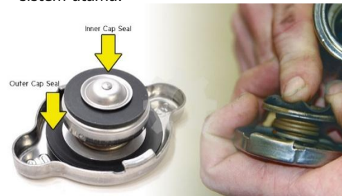
Gambar 8. Pengecekan Tutup Radiator
