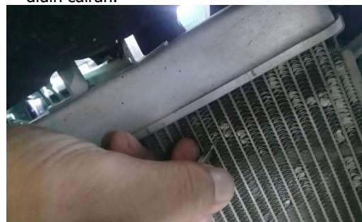
Gambar 3. Saluran Dalam Radiator Terhambat
