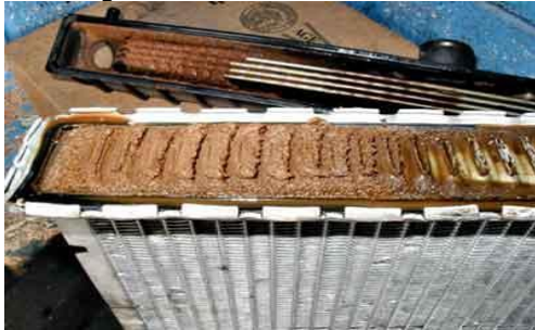
Gambar 10. Korosi Pada Radaitor
