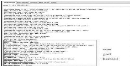
Gambar 10. Kondisi Snort Network Intrusion Prevention System tidak aktif
