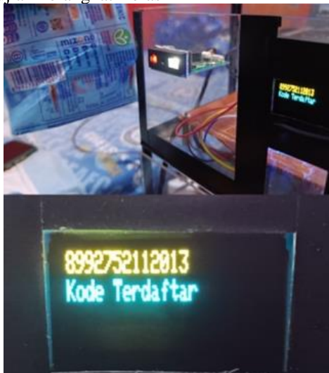
Gbr. 8 Hasil Pengujian Sensor Barcode Dan LCD Oled
