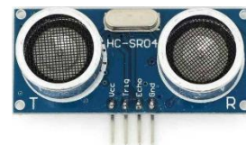
Gbr. 5 Sensor Ultrasonik HC-SR04
