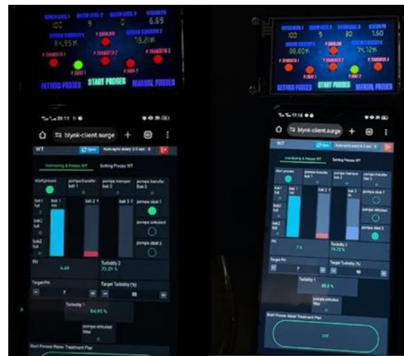
Gbr. 15 Indikator pompa obat 1 dan 2 on pada kedua sistem sinkron
