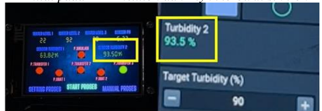
Gbr. 9 Hasil nilai sensor Turbidity pada HMI Nextion dan Blynk
